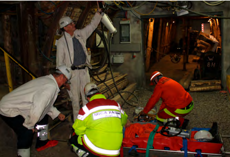
Abb. 7: „Freimessen“: Eine autorisierte Fachkraft aus dem Bergbau misst den Gehalt von Methan in der Umgebungsluft zur Vermeidung von Schlagwetterereignissen (Explosionen). Erst danach dürfen externe Geräte betrieben werden.
